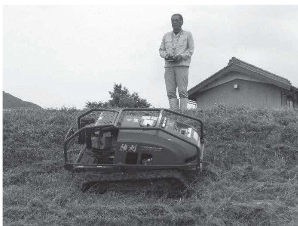
無線操縦の草刈り機導入で、作業の効率化を図る
