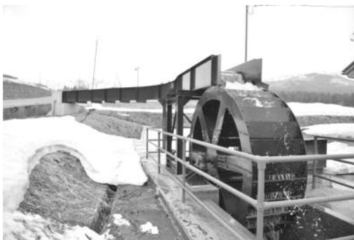
すぐそばの農産物加工施設に電力を供給する 上掛け式水車
