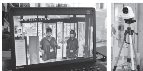
▲体温測定用カメラと体温確認用のパソコン。 発熱時はカメラから音と光が出る。
