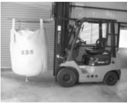
「フレキシブルコンテナ」 直径1.3m 高さ1.2mの袋で、底のロープを解くと全開し堆肥が出ます。
