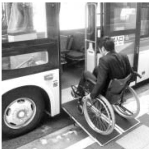
バス車両の更新に併せて低床型バス(ノンステップバス)やリフト付きバスを導入し車両のバリアフリー化を進めています。
