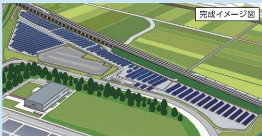
太陽光発電設備のほか、蓄電池も設置し、災害時には非常用電源として利用します。休日の昼間を中心に発生する余剰分の電力は、隣接するサカタインクス社に供給する予定です。
