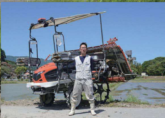
▲山根さんの会社にある先端技術の直進アシスト機能付き 田植え機
