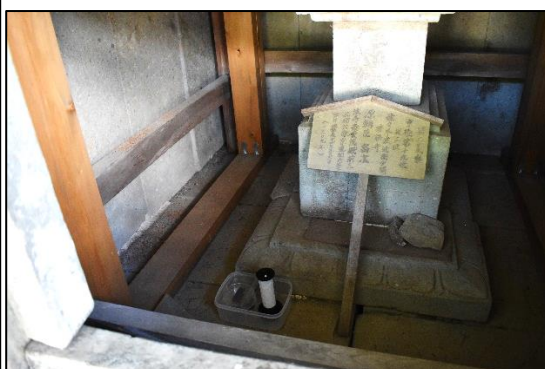
③京極高次石廟内 左：保護覆屋を架けた石廟外観 右：石廟内は狭く、円筒濾紙と温湿度データロガは床の上に設置した（現在は高さ 30cm の台上に設置している）。
