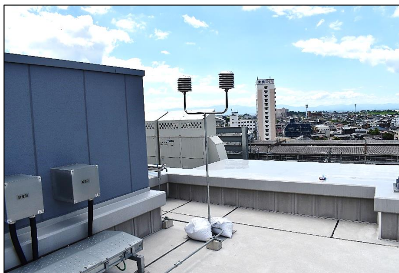
①米原市役所（屋上） 高さ 1.8mの 2つのシェルターに円筒濾紙と温湿度データログを装置した。
