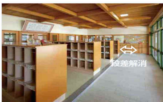
左：段差のない昇降口の例
