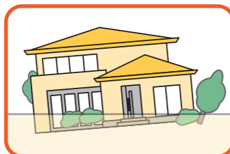
液状化による被害
