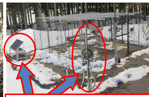
I C Tを用いた わなの遠隔監視・遠隔操作システム
