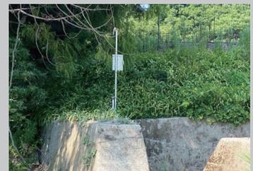
万が一土石流が発生した場合、勝山谷川に設置したセンサーが感知し、麓の警報サイレンが鳴る仕組みになっています。
