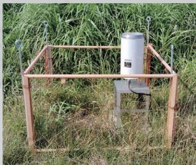
伊吹山に降る雨量を計測するための雨量計を設置しました。
